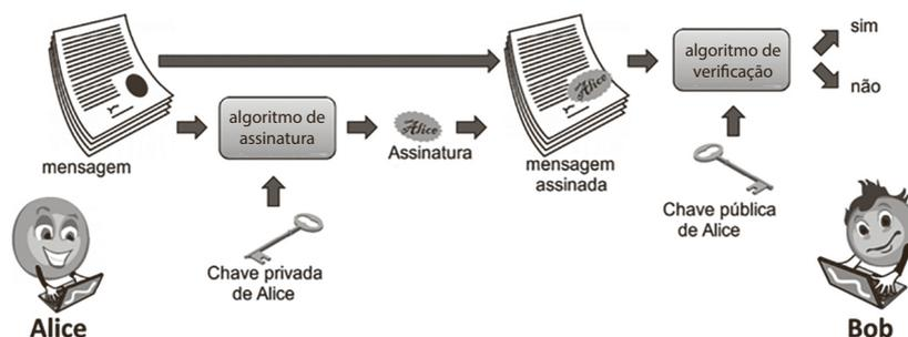
**Figura 10.** Processo de assinatura digital de Alice e de verificação de assinatura por Bob.
